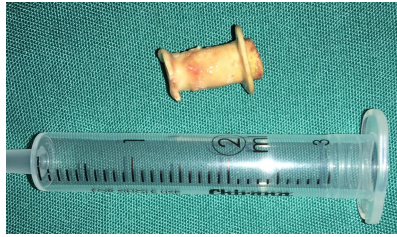
Фигура 1 Гласова протеза 13 месеца след имплантация с белези на биофилм, крайно износване и дефекти по материала
