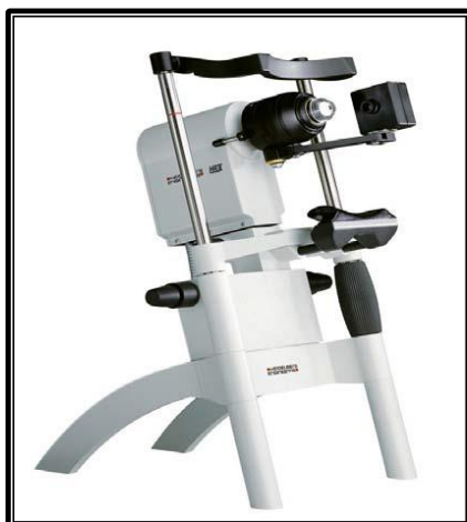
Фигура 1. HRT 3-RCM се състои от основната част на микроскопа, глава на микроскопа и съответния обектив, камера, монтирана на странично рамо, позиции за положението на пациента – подбрадник и поставка за челото.
