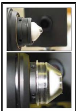
Фигура 3. Подготовка на обективната леща, поставяне на визкозната субстанция(горе) и покриване с Томо-Сар(долу)
