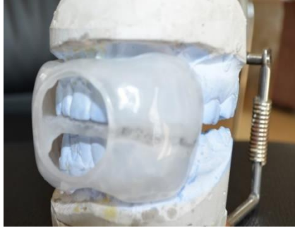
Фиг. 46 Страничен поглед- вижда се позиционирането на зъбите в леко отворена захватка, въздушното пространство, предвидено за реминерализиращия гел и отворът за поставяне на накрайника на фонофоратора
