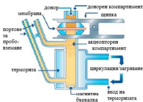
Фигура 2: Вертикална дифузионна клетка на Franz (тип 3) 25 mm диаметър и акцепторен компартимент с обем 10 mL.
