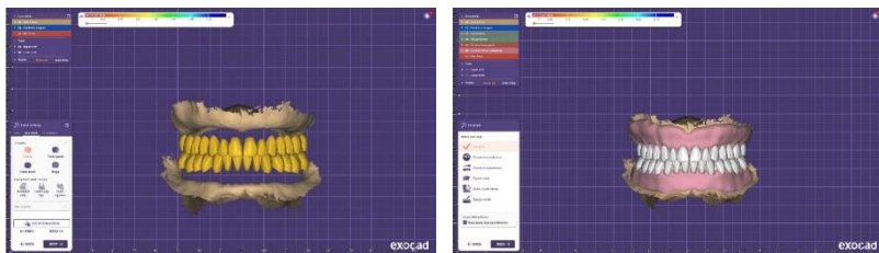
Фиг. 8 Виртуален дизайн на горна и долна цели протези
