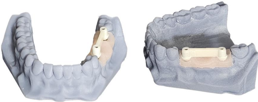
Фиг.9 Пробни тела от циркониев диоксид получени по метода на сканиране на аналог.
