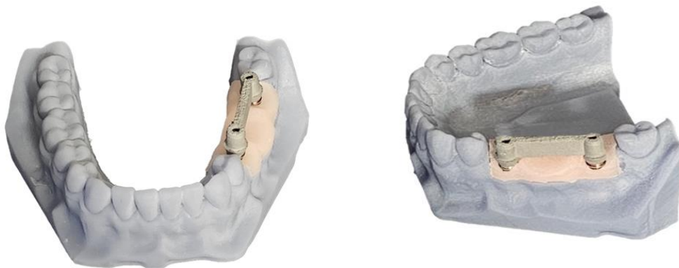
Фиг.16 Пробни тела от Co-Cr фиксирани върху модела
