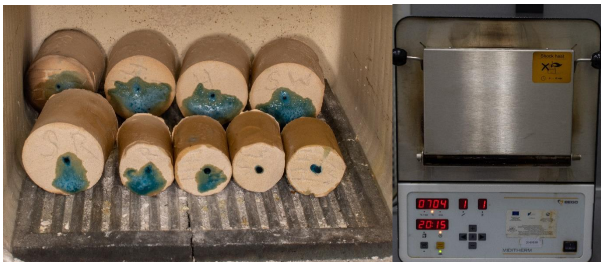
Фиг.10. Муфи с опаковани пробни тела с помощта на опаковъчна маса WiroFine® (BEGO™), поставени в пещта при температура от около 700°C.
