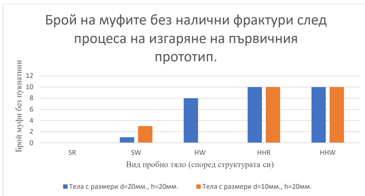
Фиг.45. Графично са изложени резултатите от всички проведени опити при описаните условия. С абривиатурите са обозначени: SW – плътно тяло от смола Castable Wax ® , HW – кухо тяло от смола Castable Wax ® , HHW – кухо тяло с отвор от смола Castable Wax ® , SR – плътно тяло от смола Castable Resin ® , HHR – кухо тяло с отвор от смола Castable Resin ® .
