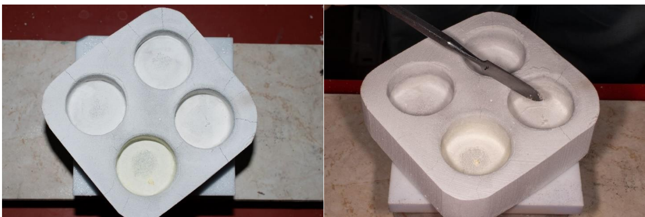
Фиг.29. Пепелен остатък генериран от опитните образци, изработени от четирите различни обследвани материали.
