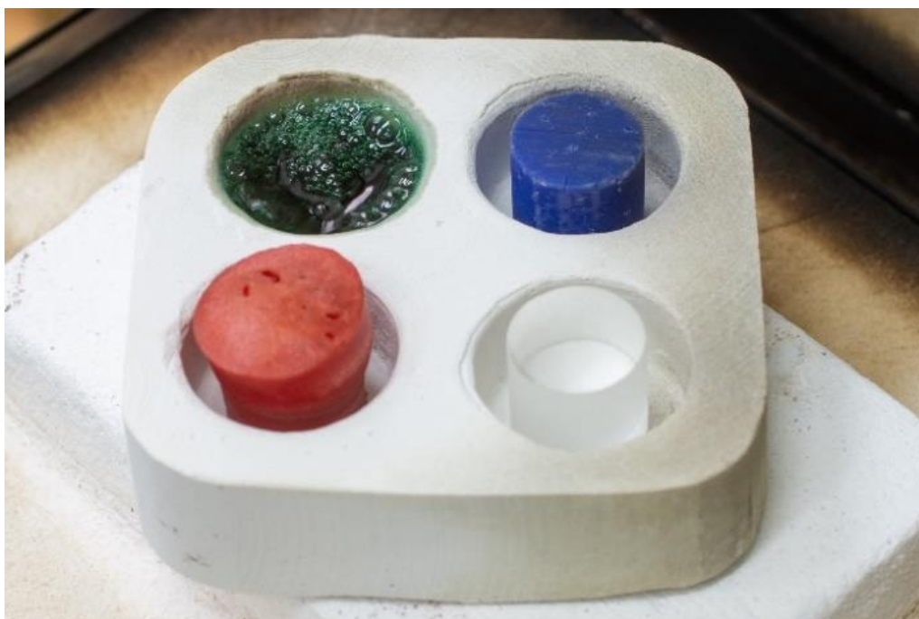
Фиг.22-Б. Обследваните образци след 10 мин. задръжка на 250°C.
