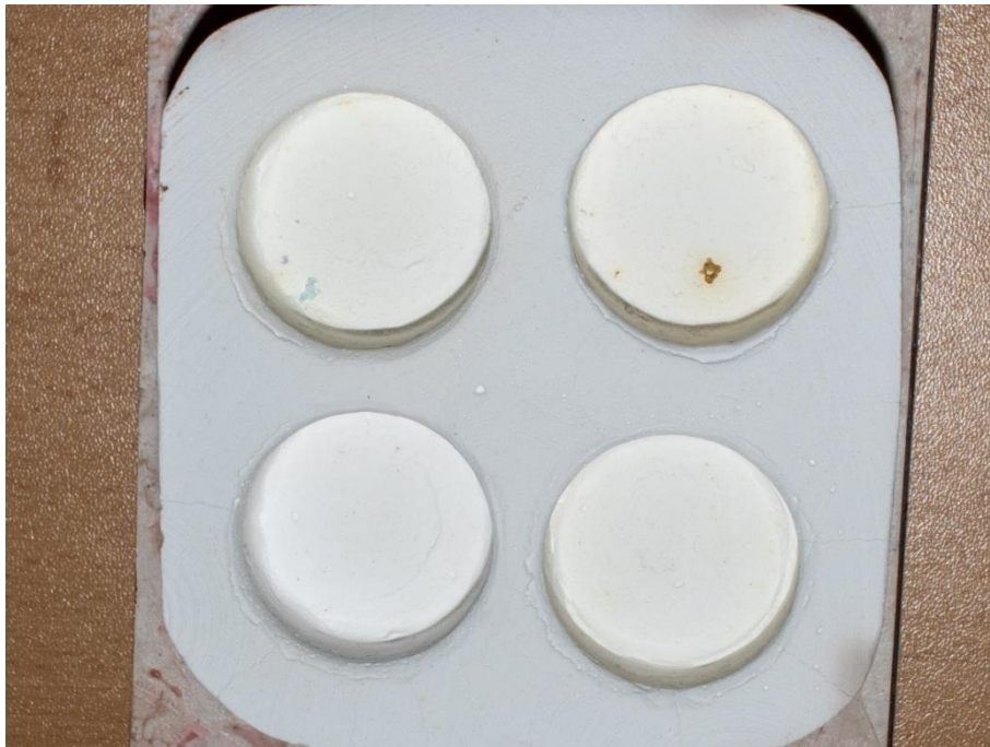
Фиг.28. Крайният резултат от темпериране на детайлите при 1050°C.
