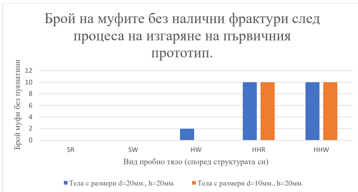
Фиг.41. Графично са изложени резултатите от всички проведени опити при описаните условия. С абривиатурите са обозначени: SW – плътно тяло от смола Castable Wax ® , HW – кухо тяло от смола Castable Wax ® , HHW – кухо тяло с отвор от смола Castable Wax ® , SR – плътно тяло от смола Castable Resin ® , HHR – кухо тяло с отвор от смола Castable Resin ® .
