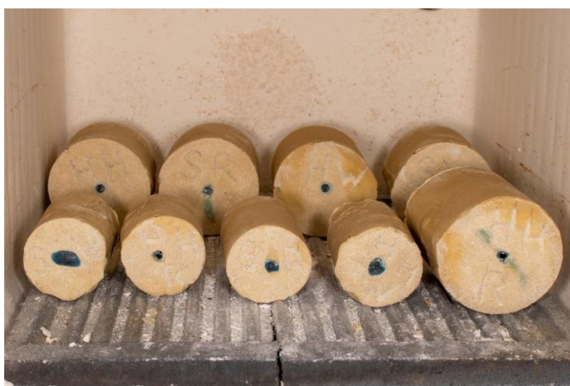
Фиг.9. Муфи с опаковани пробни тела с помощта на опаковъчна маса WiroFine® (BEGO™), поставени в пещта при температура от 25°C.
