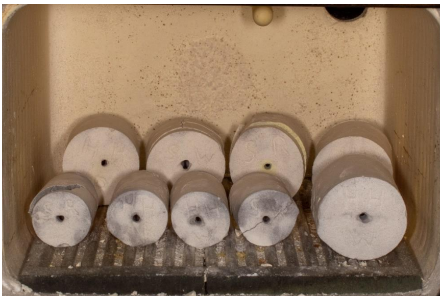
Фиг.44. На изображенито е показана една група от изследваните муфи при температура от 1050°C. Не се установяват значителни разлики в сравнение с 250°C.
