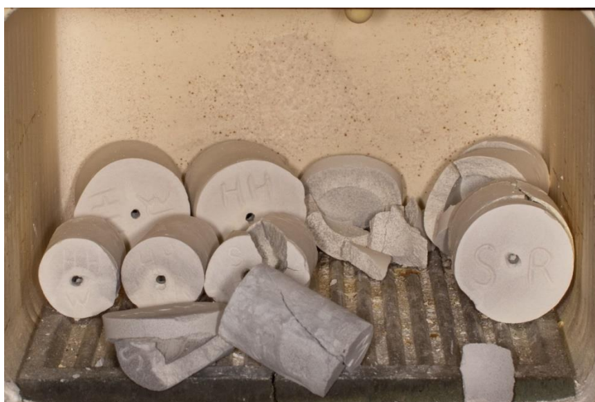
Фиг.40. Изпитваните муфи при температура от 980°C.
