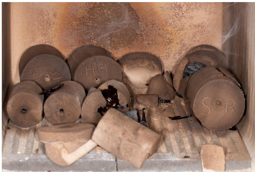
Фиг.39. Отчетените резултати след след 30 мин. задръжане на температурата на 350°C. Муфите на плътните и кухите тела, с изключение на тези с отвор, са разрушени напълно.
