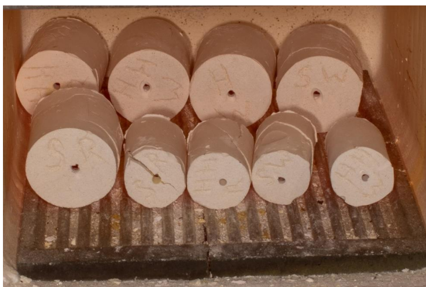
Фиг.47. Подгретите муфи на 1050°C, след 60 мин. задръжка, препоръчана от фирмите производители на смолата и опаковъчната маса.
