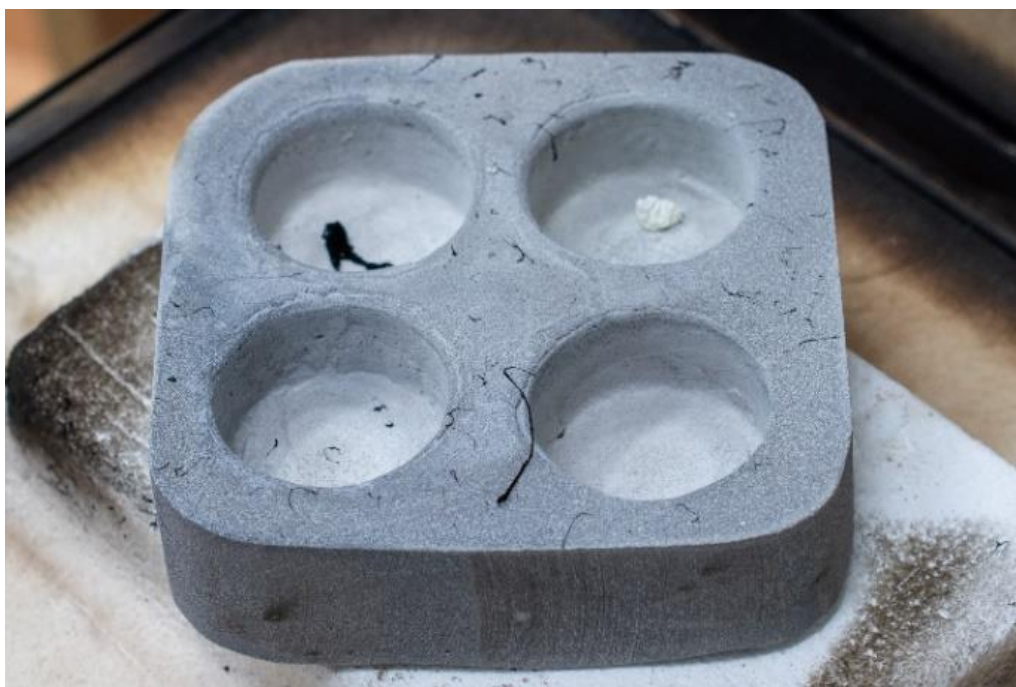
Фиг.27. Наличният пепелен остатък при 600°C.
