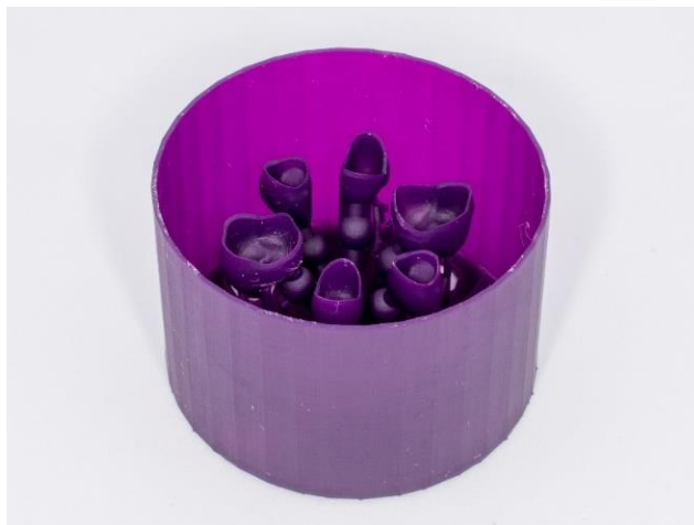
Фиг.51. Полученият резултат е детайл, състоящ се от: 3D принтирани монолитно отливен пръстен и конус, отливни щифтове, резервни депа за метал и прототипи на конструкции.
