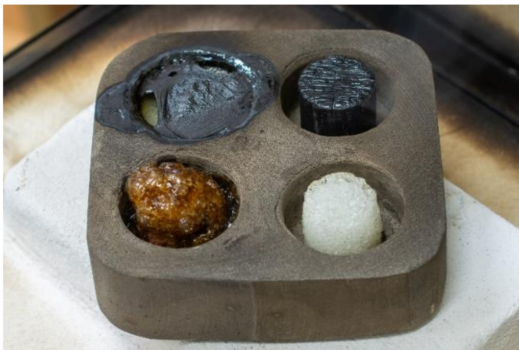
Фиг.25. Опитните образци при температура от 400°C, след задръжка.
