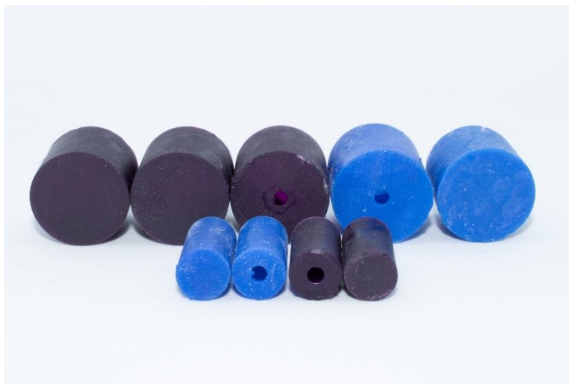
Фиг.5. На фигурата е изобразен по един представител от изработените групи пробни обекти. Телата, 3D принтирани от смола Castable Wax ® , имат форма на цилиндър и биват: кухи, кухи с отвор и плътни, с размери: диаметър – 20 мм., височина – 20 мм. и такива с диаметър 10 мм. и височина 20 мм. Идентични по форма, размер и структура тела са представени и от смола Castable Resin ® .
