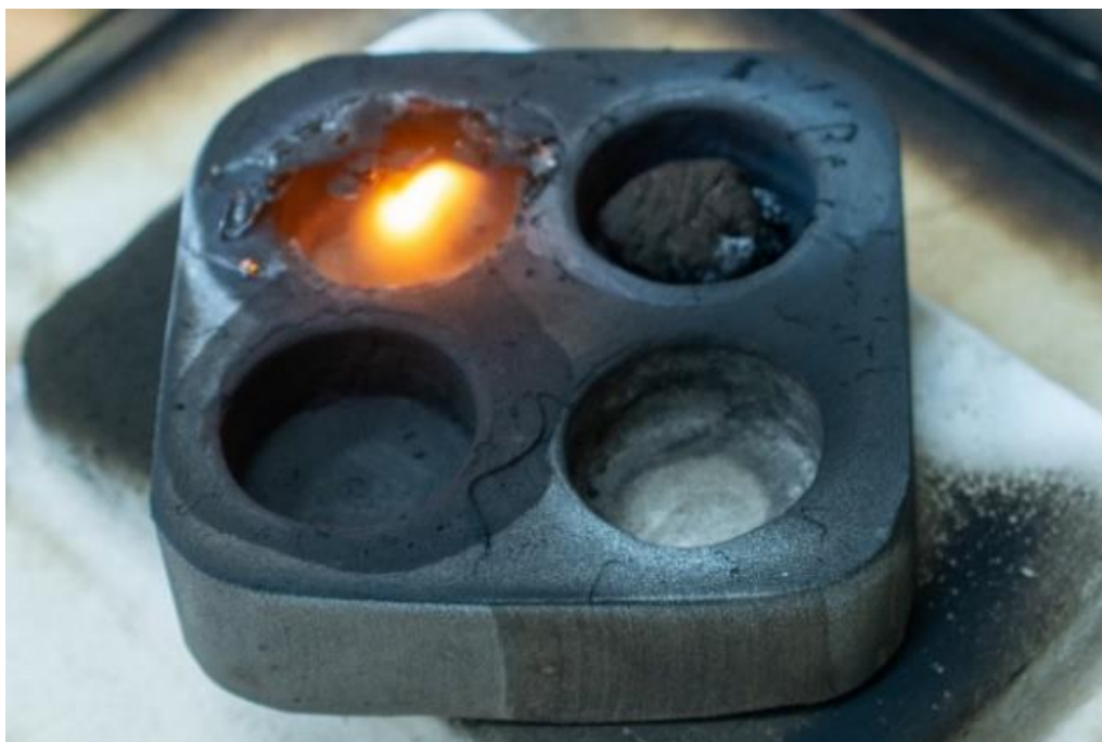
Фиг.26. Наличните фрагменти от детайлите след процеса на бурно горене, отчетени при 550°C.
