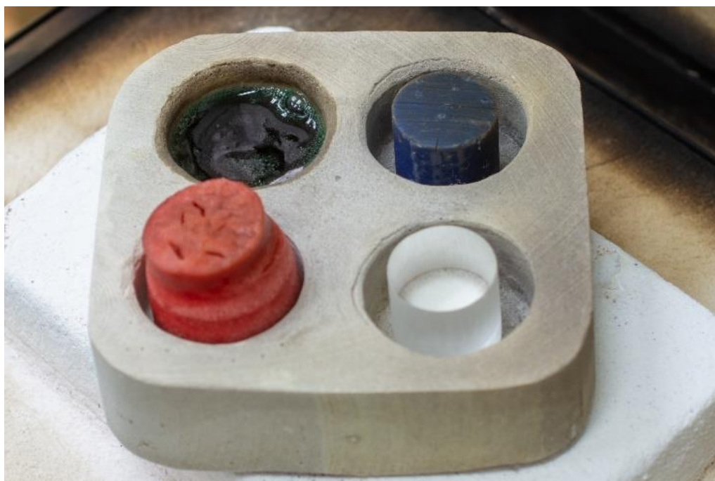
Фиг.23. Опитните образци при температура от 300°C, след 10 мин. задръжка.
