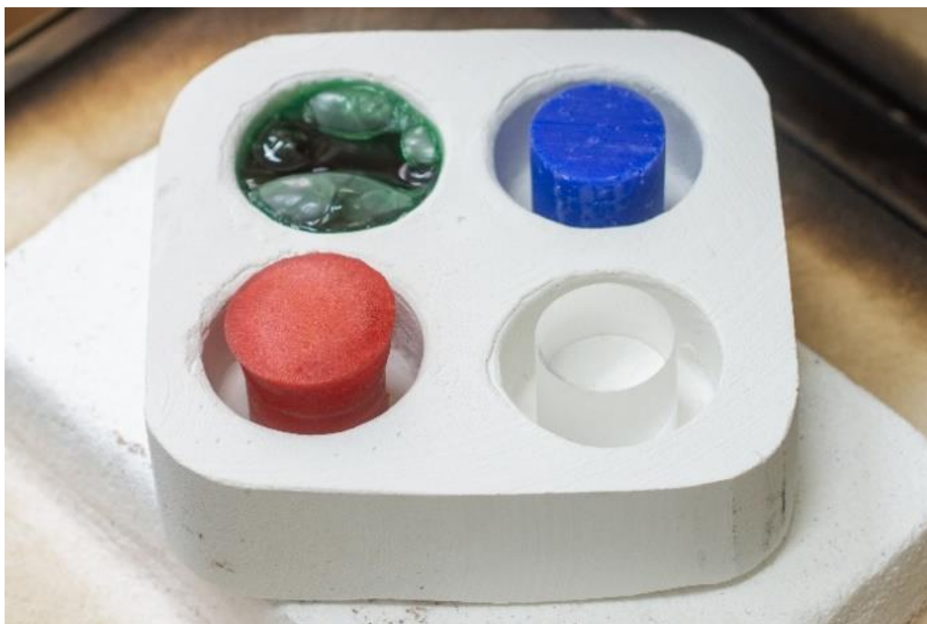
Фиг.22-А. Обследваните опитни тела при достигане на температура от 250°C.
