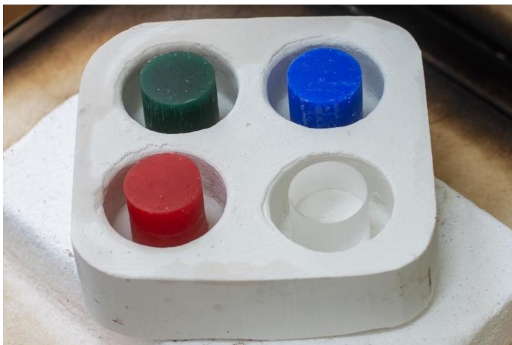
Фиг.19. Опитните тела при температура от 100°C.
