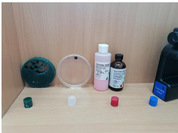
Фиг.1. На снимката от ляво на дясно са изобразени опитните тела както следва: CAD/CAM wax (Yeti Dental™), C-cast® (KaVo Dental™), Pattern Resin LC® (GC™) и Castable Resin® (Formlabs™).
