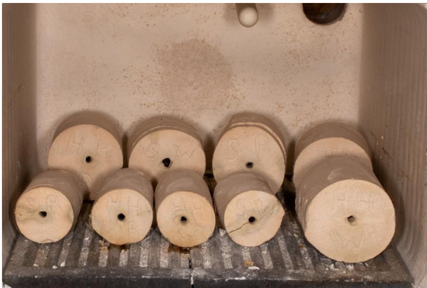
Фиг.43. Изследваните обекти след 30 мин. задръжка на температура 250°C. Забелязват се пукнатини по муфите, маркирани с SR и SW от двата изследвани размера.
