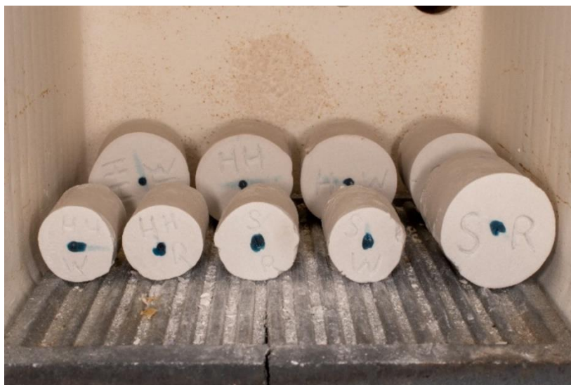
Фиг.8. Изработените муфи, въведени в пещта при температура от 25°C.
