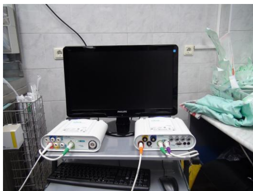
Фиг. 6.1.7.1 Xitek – апаратура за създаване на интраоперативни симултантни евокирани потенциали
