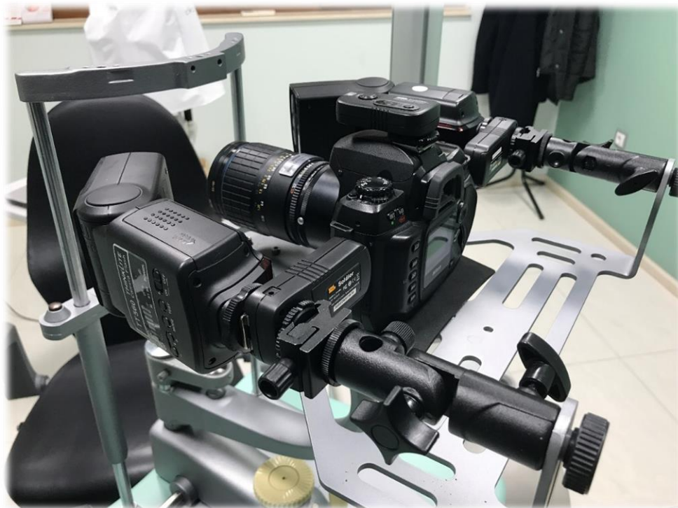
Фиг. 11 Използвана установка на камерата за детекция на увреждания по ПОП – страна на изследващия, стойка и подбражник
