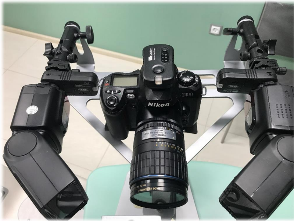
Фиг. 10 Използвана установка на камерата за детекция на увреждания по ПОП, тяло и светкавици
