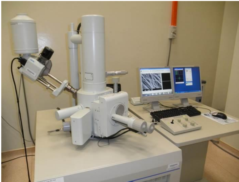
Фигура 5: Сканиращ електронен микроскоп модел Jeol - JSM - 6390
