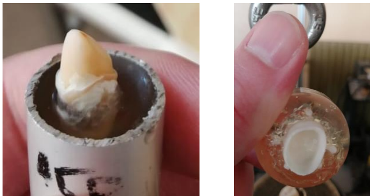
Фиг. 6. Отлепена циркониева корона на вече тестван образец
