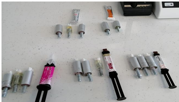
Фиг. 37. Част от образците подложени на тест на сила на връзката с използваните цименти
