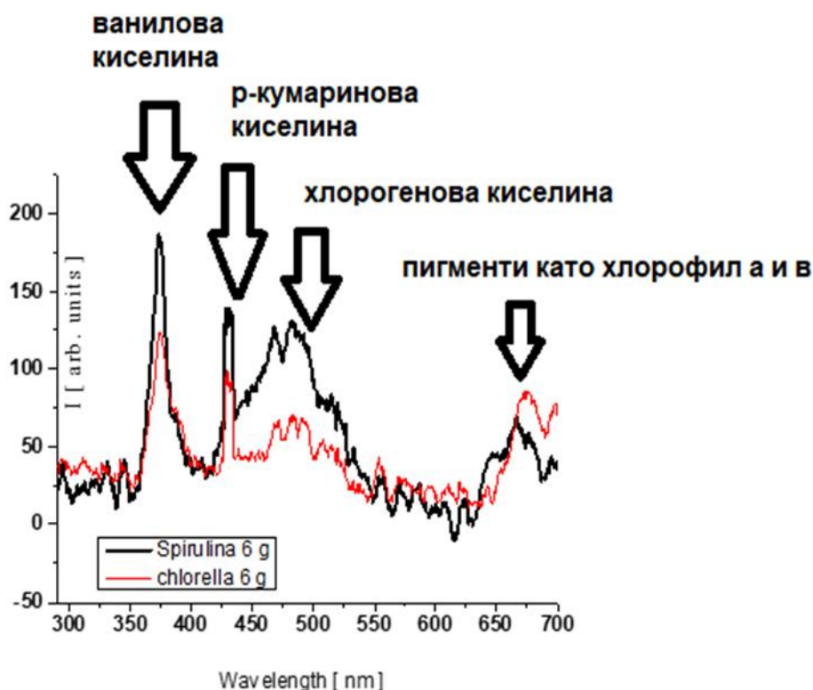
Фигура 13. Флуоресцентни спектри на инфузи от Spirulina и Chlorella при възбуждаща светлина с дължина на вълната 290 nm
