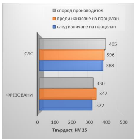
Фиг. 3-12 Микротвърдост на образци от сплав Ti6Al4V.
