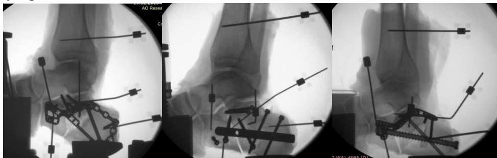
Фиг.91 Биомеханично тестване на различните импланти. ( AO Research Institute Davos )
