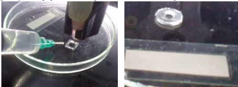
Фиг. 33: Калибрационен куб и калибрационен цилиндър, изработени с Модификация 1. По време на 3D принтирането обектите са обливани с разтвор на \text{CaCl}_2 за подобряване на стабилността им
