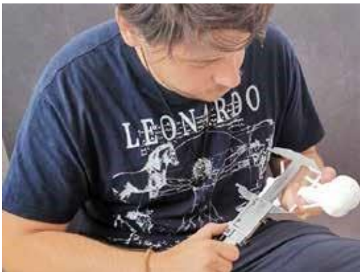
Фиг. 7: Измервания с мануален шублер
