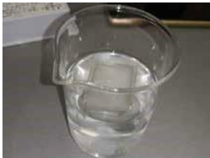
Фиг. 16: Полимеризиране на блокче в разтвор на CaCl 2
