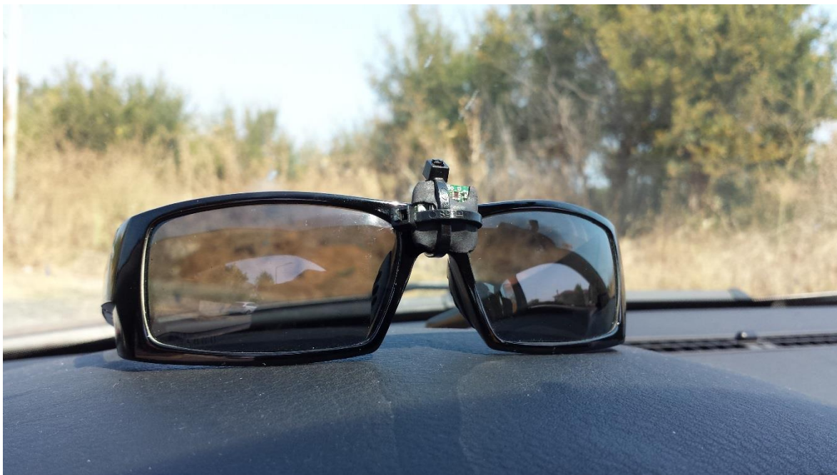
Фигура 26 – UV дозиметъра монтиран на фронт на слънчеви очила.
